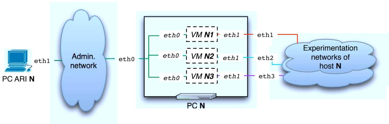
FIGURE 3 – Configuration des 3 VM de la plate-forme
