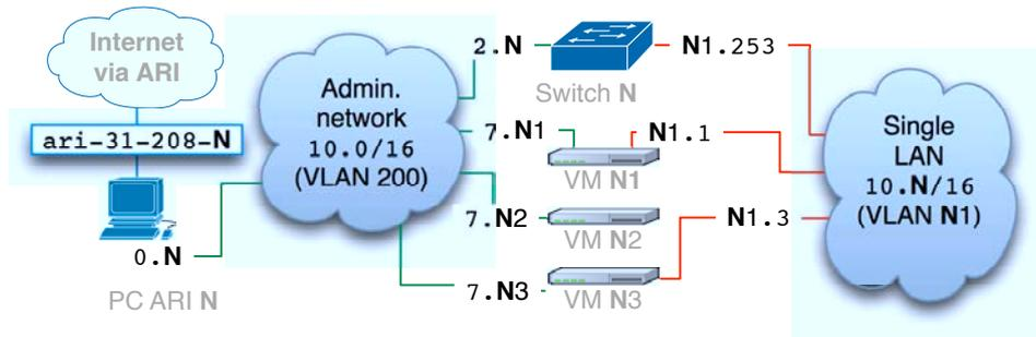
FIGURE 5 – Topologie virtuelle 1 (un LAN)
