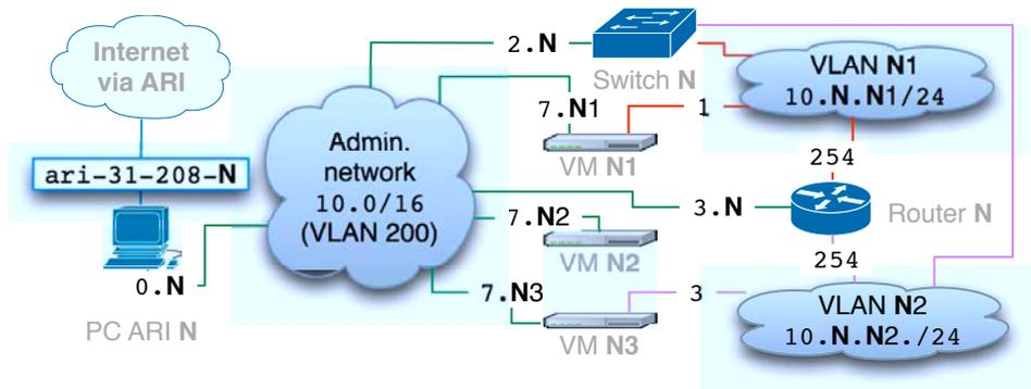
FIGURE 6 – Topologie virtuelle 2 (deux LAN et un routeur)
